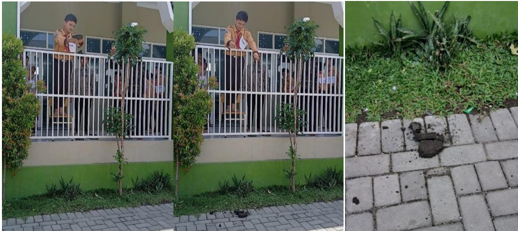
Gambar 13. Uji kekuatan paving block
