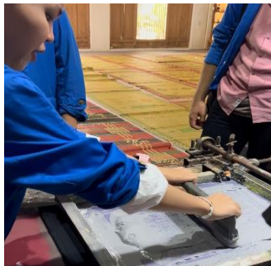
Gambar 2. Peninjauan Proses Produksi dan Teknik Cetak Saring Manual Omah Oblong
